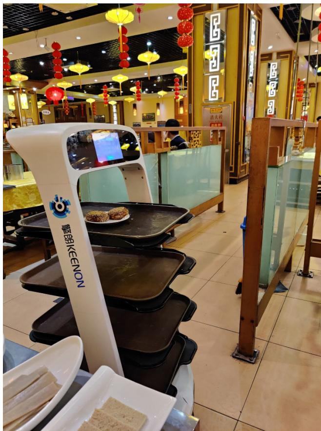
Foto 2: Izvrstan je primjer pekinškoga restorana u kojemu su robot i konobarica u simbiozi, što znači da robot nosi hranu, a konobarica hoda pored radnoga robota i poslužuje goste s robota. Fotografirao Goran Đurđević. Peking.
